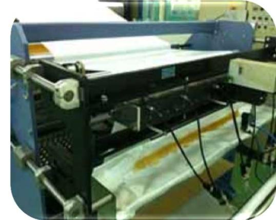
La aplicación de adhesivo, puede realizarse en superficie completa, o dejando marcas sin adhesivo, mediante el cambio del tipo de galga.
