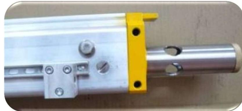
**QLE**, es una quemador lineal a gas, diseñado para realizar el proceso de fusión superficial de espumas termoplásticas, en máquinas de laminación a la llama.
